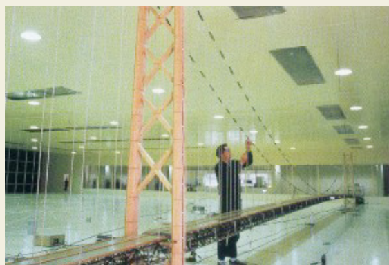
写真2 明石海峡大橋の全橋風洞模型（本州四国連絡高速道路株式会社 提供）
