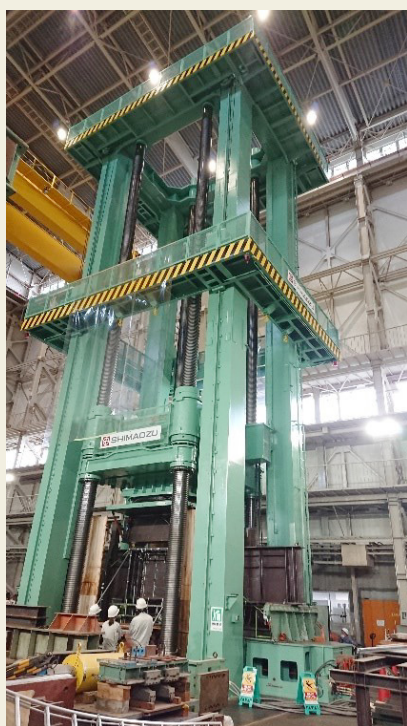
写真1 大型載荷試験機 （（国研）土木研究所所有、筆者撮影）
